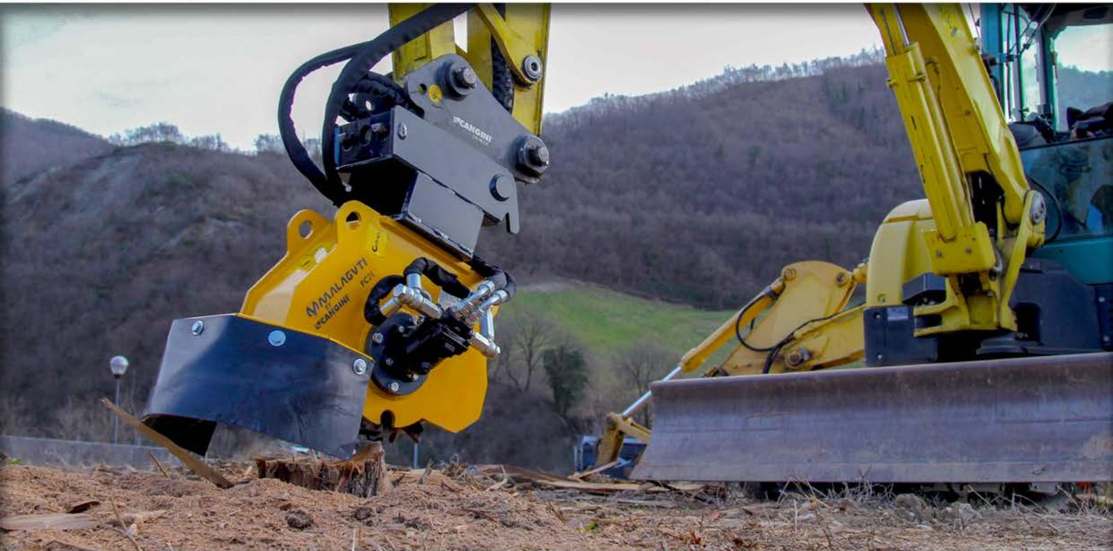
RAPIDA ED EFFICACE, L'ATTREZZATURA È UTILE PER LA FRESATURA DI CEPPI E MATERIALE LEGNOSO ANCHE IN PROFONDITÀ BRANDEGGIANDO LA RUOTA DENTATA DA UN LATO ALL'ALTRO E AVANZANDO GRADUALMENTE NEL CEPPO FINO A ELIMINARLO COMPLETAMENTE. IL SISTEMA DI TRASMISSIONE DIRETTA CON MOTORE A PISTONI FORNISCE LA MASSIMA VELOCITÀ DI TAGLIO E QUINDI UNA PRODUTTIVITÀ E UN'EFFICIENZA OTTIMALI. I DENTI IN TUNGSTENO DI CARBURO SONO ALTAMENTE RESISTENTI. L'ATTREZZATURA È COMPRESA DI ATTACCO ALLA MACCHINA.
